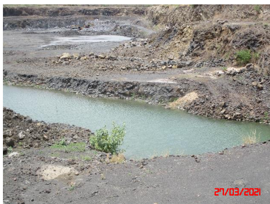
รูปที่ 2-8 บ่อรับน้ำ (Sump) ขุมเหมือง
